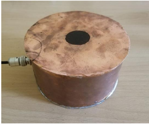
სურათი 9. ცილინდრული ფორმის ეკრანი 27mm დიამეტრის ზომის ხვრელით
