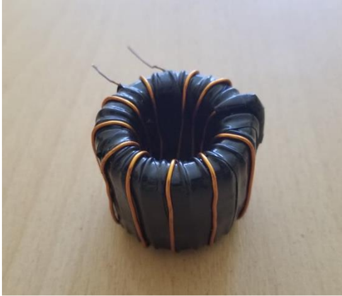
სურათი 5. N30 ტიპის მაგნიტური ტოროიდალური გულარის გამოყენებით შექმნილი ტრანსფორმატორი
