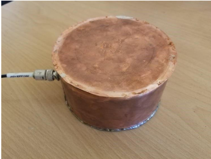
სურათი 8. სპილენძის ცილინდრული ფორმის დახურული ეკრანი
