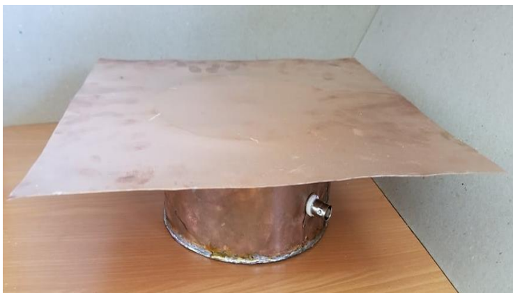
სურათი 10. ცილინდრული ეკრანი კვადრატული ხუფით. მასალა - სპილენძი. სისქე 0.2 mm.
